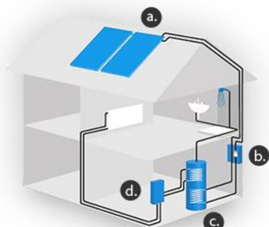
Za razliku od peleta, solarni toplinski sistemi su puno poznatiji i imaju rašireniju upotrebu. Oni se koriste za potporu niskotemperaturnom površinskom grijanju, te za pripremu potrošne tople vode. Pri pravilnom dimenzioniranju, solarni toplinski sistemi godišnje mogu uštediti i do 70% energije za pripremu potrošne tople vode godišnje, a do 30% za pripremu potrošne tople vode i potporu niskotemperaturnom površinskom grijanju.
